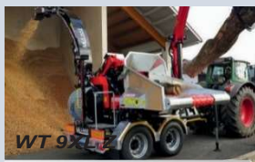
Otwór (SxW) max. 82 x 70 cm Wydajność: do 130 mp/h
