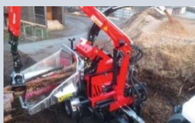
WT 11 Z Otwór (SxW) max. 114 x 75 cm Wydajność: do 200 mp/h
