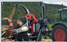
Otwór (SxW) max. 64 x 60 cm Wydajność: do 100 mp/h
