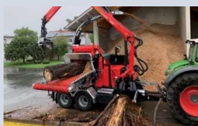
WT 11 XL Z Otwór (SxW) max. 135 x 80 cm Wydajność: do 240 mp/h
