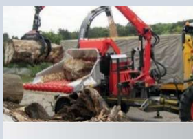
WT 12 Z Otwór (SxW) max. 135 x 90 cm Wydajność: do 300 mp/h
